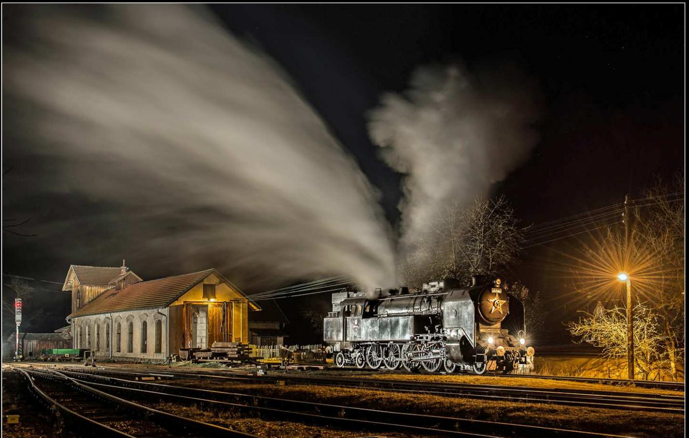
Louny, Nymburk und Pízeň zu 1'Dh2-Heißdampfloks umgebaut. Nach Abschluss der Arbeiten verließen diese Loks als Reihe 434.2 (434.201 bis 299 und 2100 bis 2345) die Werkhallen. Durch den Umbau konnte die Leistung um fast 20 % gesteigert werden.
