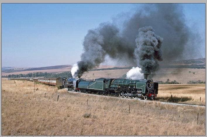
Auch die Anreisen erfolgten mit Stil und passend, hier der Sonderzug von Johannesburg bei Klerksdorp. Gut erkennbar ist hier bei der führenden 25 NC der umgebaute Kondenstender.
