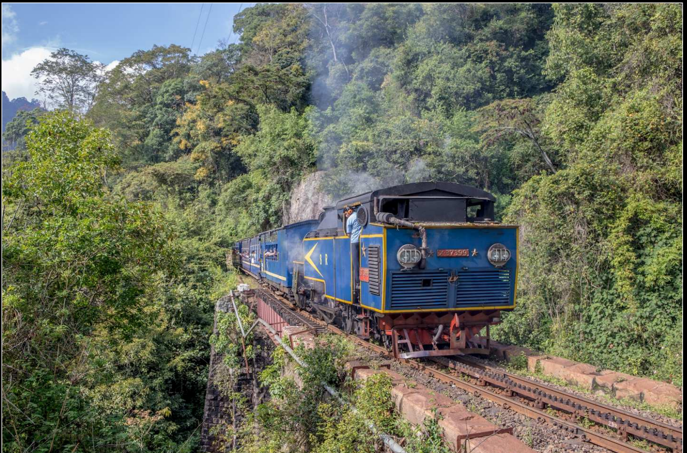
Eine Brücke zwischen Hillgrove und Runnymede ist das Motiv für die X 3739. Deutlich ist die Zahnstange in der Gleismitte zu erkennen.
