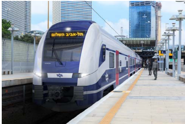
Elektrischer Desiro-Doppelstocktriebwagen (Desiro HC) für die Israel Railways. (Foto: Siemens, Samml. Th. Estler)
