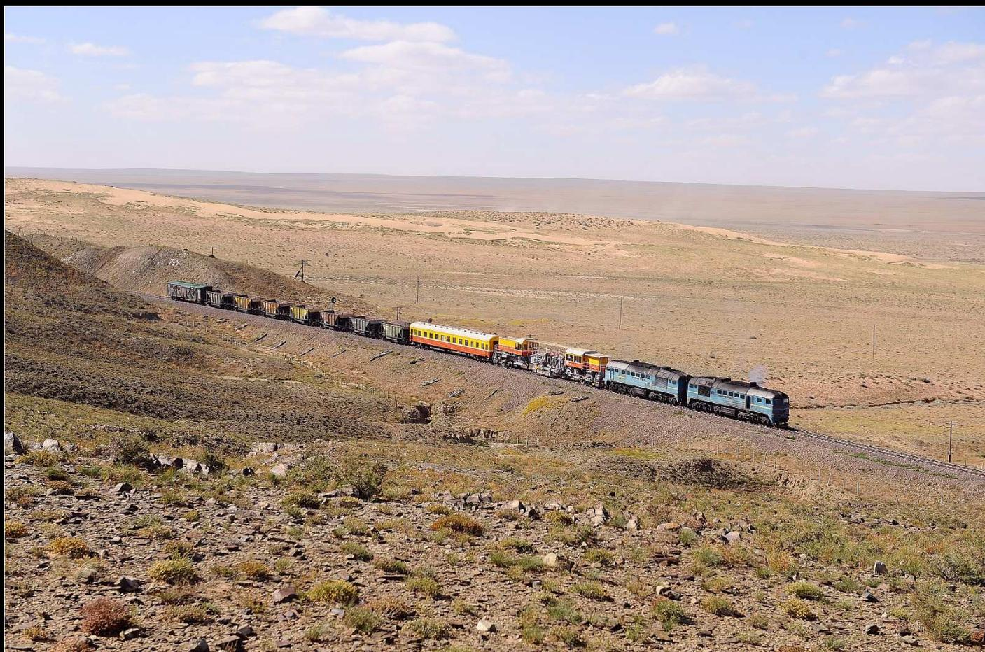
M62MM 021 B/A befördert nördlich von Tsagaan Chad einen Arbeitszug bestehend aus einer Baumaschine und einigen Schotterwagen. Hier gibt es eine Sanddüne als Bildhintergrund, selten in der Ostgobi, die überwiegend aus Steinflächen besteht. (20.09.2018)
