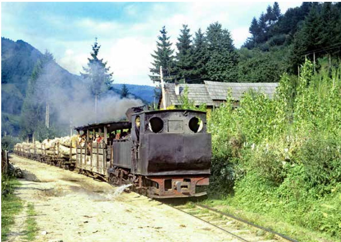
Der von 1906 bis 1950 gefertigte MÁVAG-Typ 70 war Vorbild für die ab 1951 in Reșița und später auch in Reghin produzierten Schmalspurmaschinen. Auch die CFF hatte etliche MÁVAG-Lokomotiven im Bestand. Die am 23.8.1991 auf der Waldbahn Vișeu de Sus fotografierte 764.355 stammt aus der letzten Bauserie und wurde erst 1949 in Betrieb genommen.
