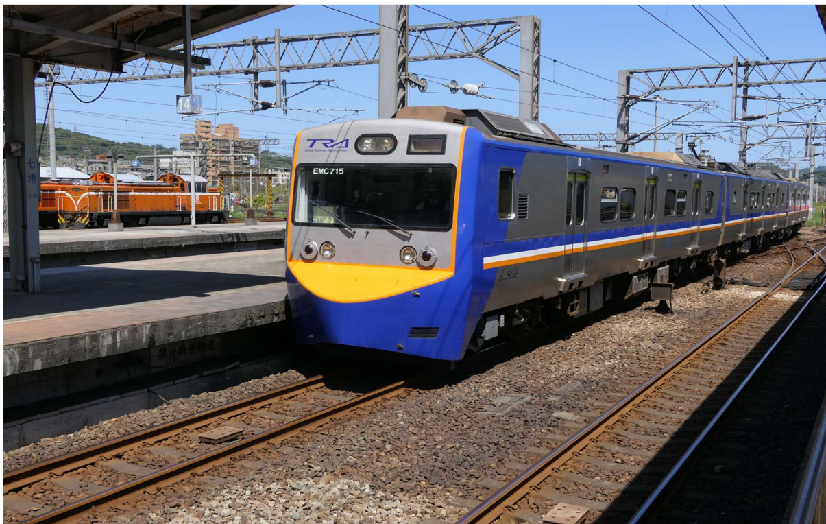
Der Regionalverkehr wird mit modernen Triebwagen abgewickelt. Hier ein Zug der EMC700er-Serie im Bahnhof Cidu. Im Hintergrund zwei diesel-hydraulische Rangierlokomotiven aus der DHL100er-Serie
