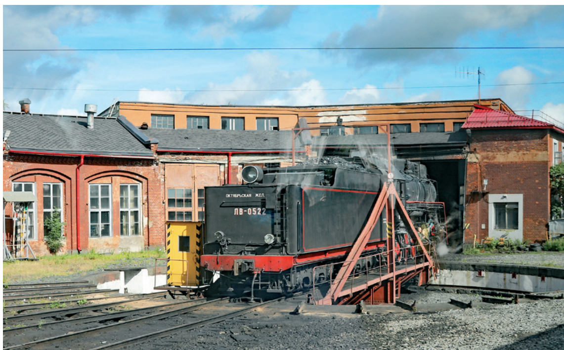
LW-0522 auf der (unterdimensionierten) Drehscheibe des Bw Sortavala. Die Maschine kann nur an der Endstation Bergpark Ruskeala gedreht werden.
