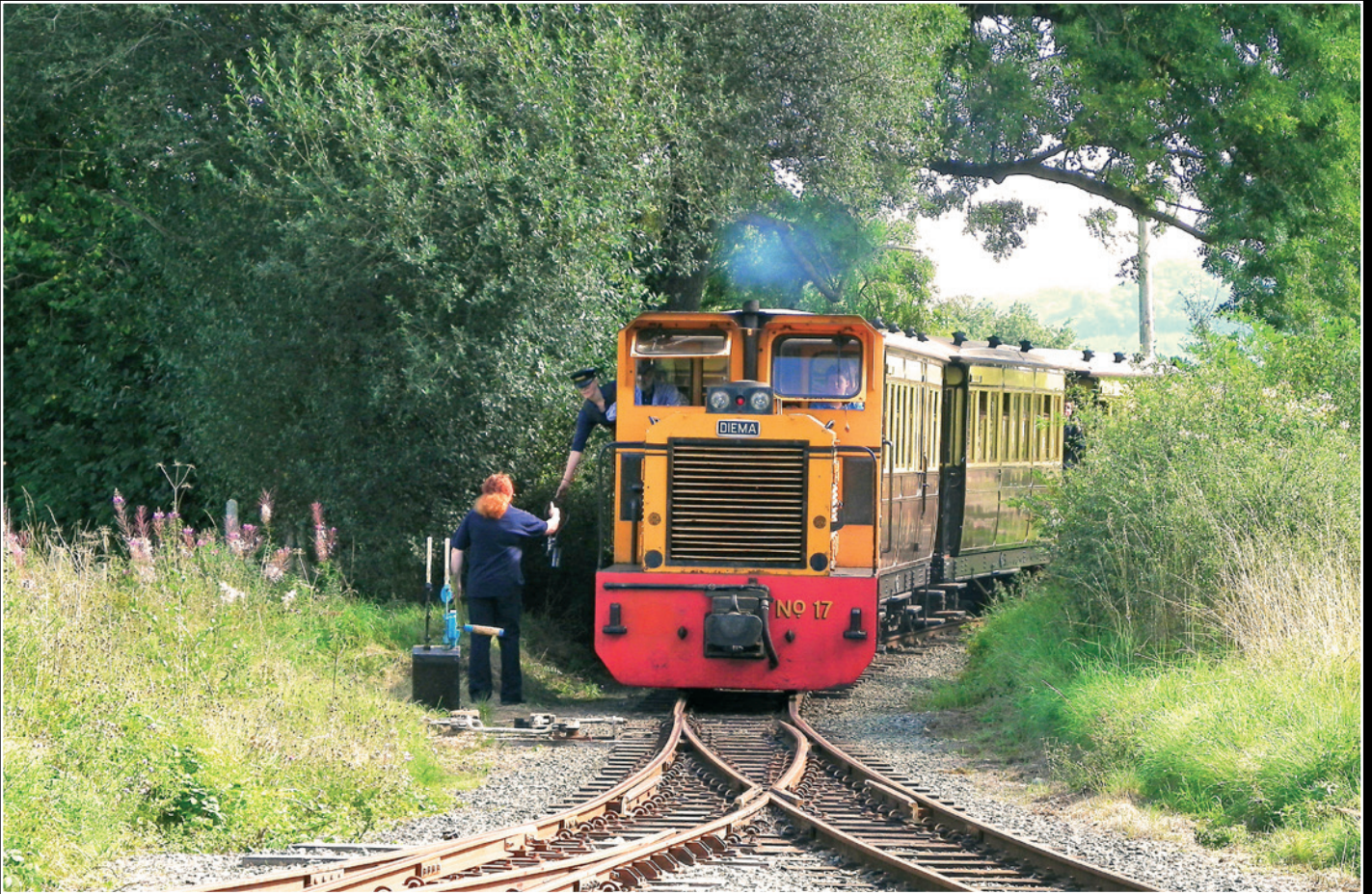
▲ Tokenübergabe bei Einfahrt der Lok 17 Diema A in Cyfronydd, der zweiten Kreuzungsstelle für die Züge der Steam Gala. Diese DIEMA A lief als Nr. 175 bei der Zuckerfabrik in Shanhua/Taiwan und kam dann zur Welshpool. Die Lok hat einen 6-Zylinder Allis Chalmers Motor, daher das "A". ▼ Der Wickham Trolley fährt von Cyfronydd als „no passenger train“ nach Llanfair Caereinion.
